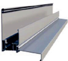
Perfil inferior con auto-drenaje y vierte-aguas
