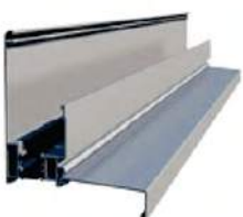
Perfil inferior con auto-drenaje y vierte-aguas
